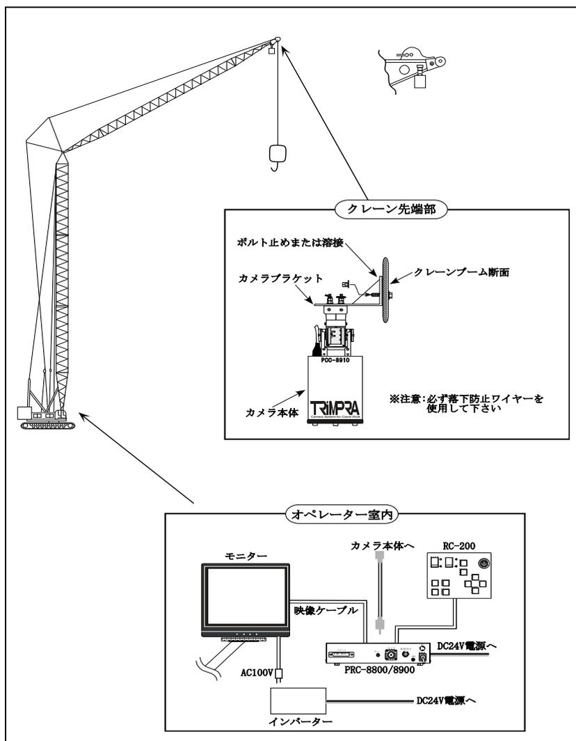
ブーム先端にカメラ本体を取り付けるブラケット(PBR-002/004)をねじ止めまたは溶接で取り付けます。
