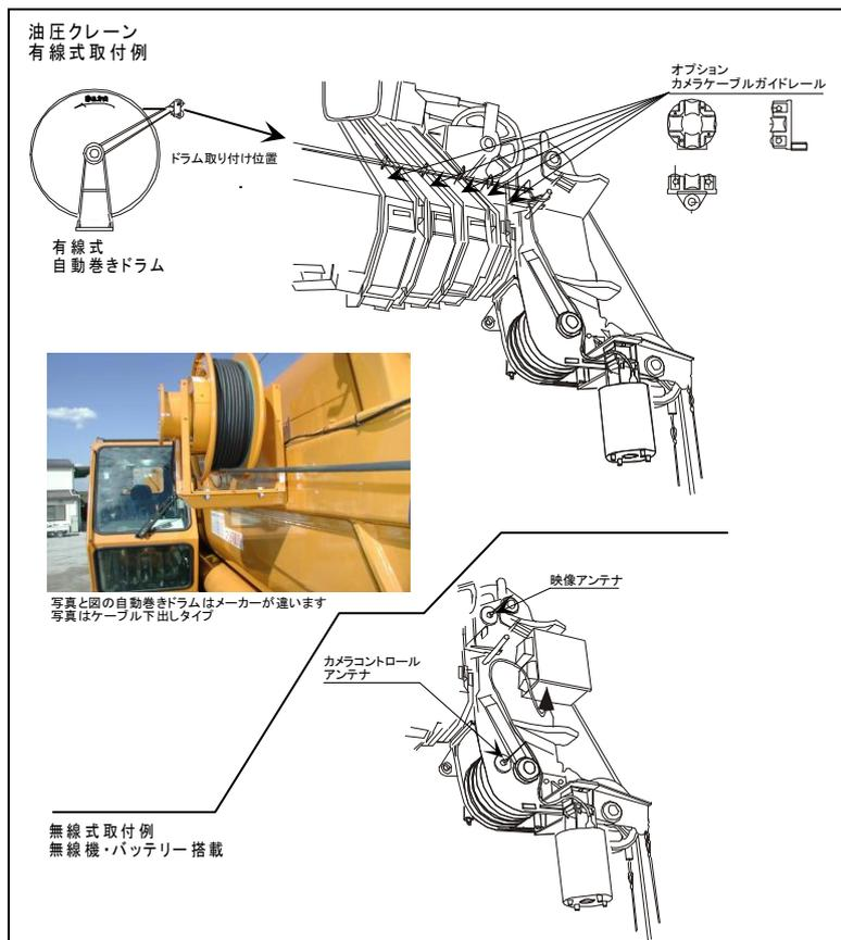
油圧クレーンはブームに取付金具を溶接し自動巻きドラムを取り付けます。必要に応じてケーブルガイドレールも取り付けます。
