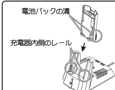
リチウムイオン電池パックを単体で充電するときは、リチウムイオン電池パックの溝を充電器内側のレールに合わせて差し込みます。
