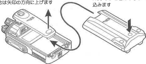
▶ 「カチッ」と音がするまで、電池パックの背面を押しながらスライドし確実に取り付けてください。
