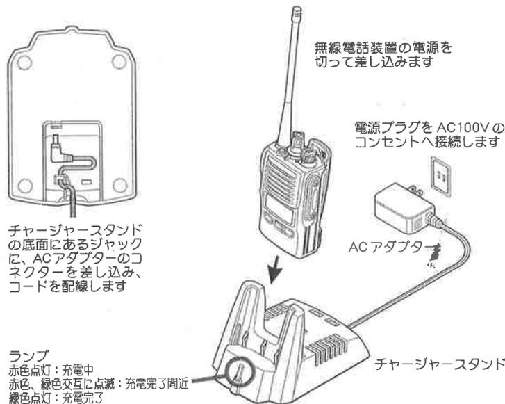
無線電話装置の電源を切って差し込みます
