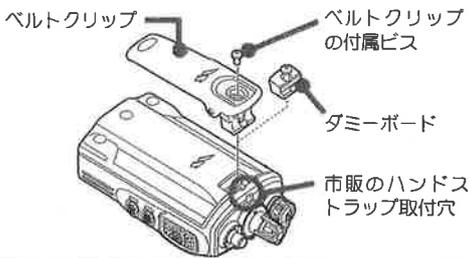
ベルトクリップの先端を指で押し、ベルトへ確実に取り付けてください。
